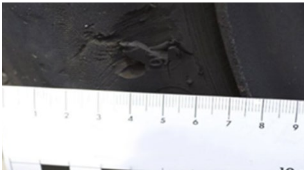
Pneumatiques: entaille > 3 mm de profondeur, arrachement
