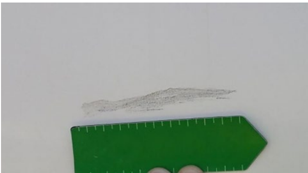
Panneaux latéraux: rayure légère avec arrachement de matière \leq 20 cm
