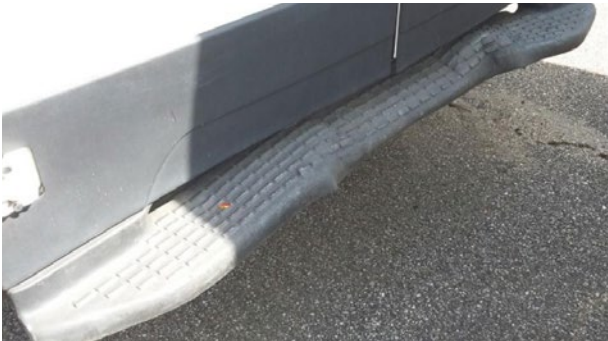
Marchepieds arrière: déformations hors limite économique de la réparation
