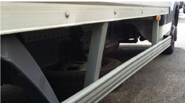
Barres cyclistes: déformation dans la limite économique de la réparation
