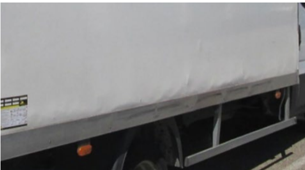
Panneaux latéraux fibre: déformation en partie basse sur une longueur > 1\text{m} NB : le remplacement du panneau de face avant de la caisse nécessite la dépose de la caisse.
