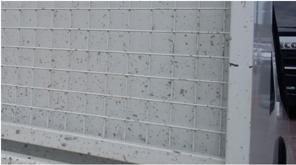
Trace de béton ou produit chimique dont la superficie \geq ¼ de la superficie de la benne
