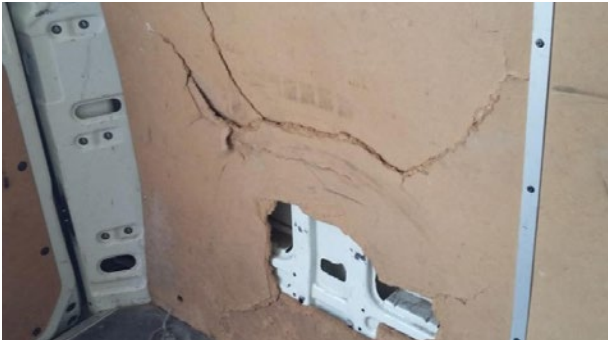
Protections intérieures bois: impacts, déchirement de panneau, absence de panneau (hors panneaux supérieur de portes)
