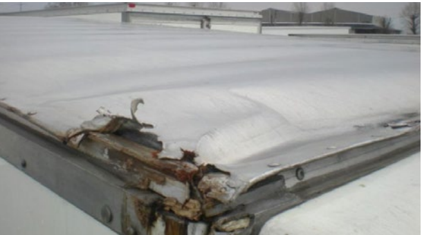
Pavillon: Cadre endommagé, peausserie hors limite économique de la réparation
