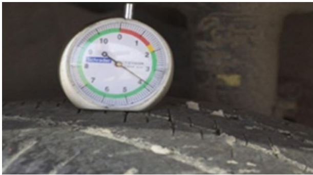
Pneumatiques: entaille > 3 mm de profondeur, arrachement
