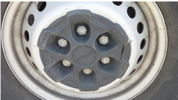
Enjoliveurs: déformé, cassé, arrachement de matière ou manquant
