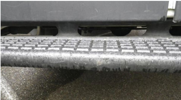
Légères rayures de la peinture au niveau des seuils de chargement
