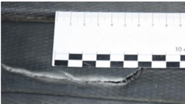
Perforation des garnitures en plastique dur: Réparation des garnitures de plastique dur forfait 1h si esthétiquement acceptable et reparable
