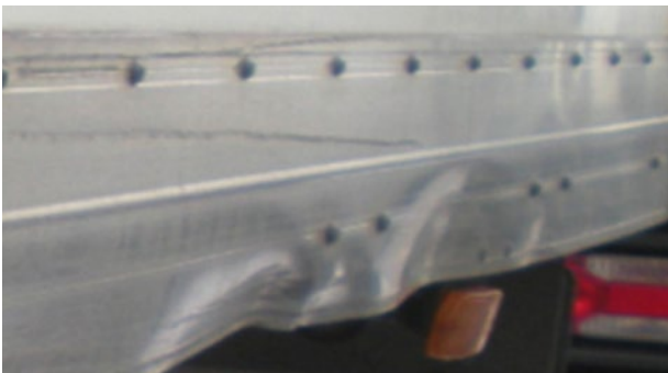
Profilés de rive de caisse: déformations hors limite économique de la réparation, perforations, arrachement d'une partie du profilé
