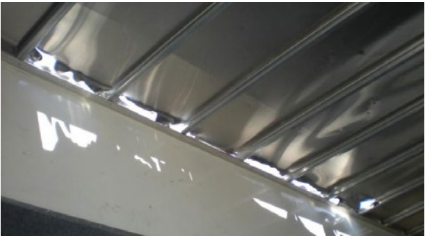
Pavillon: Cadre endommagé, peausserie hors limite économique de la réparation
