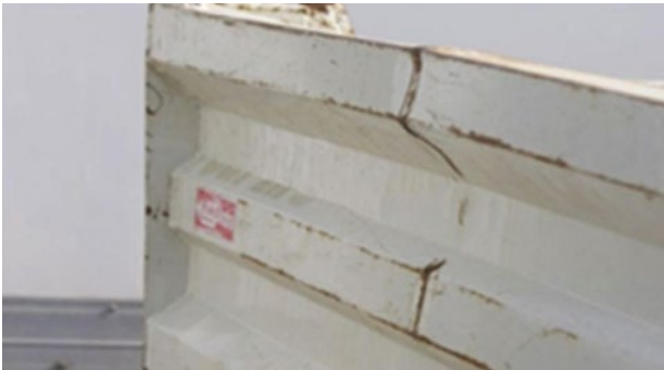
Déformations de la ridelle dont le temps de réparation > 1h et dans la limite économique de la réparation
