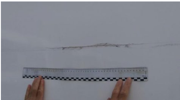
Panneaux latéraux: rayure avec arrachement de matière \geq 20\text{cm} dans la limite économique de la réparation. Possibilité de peinture en demi panneau
