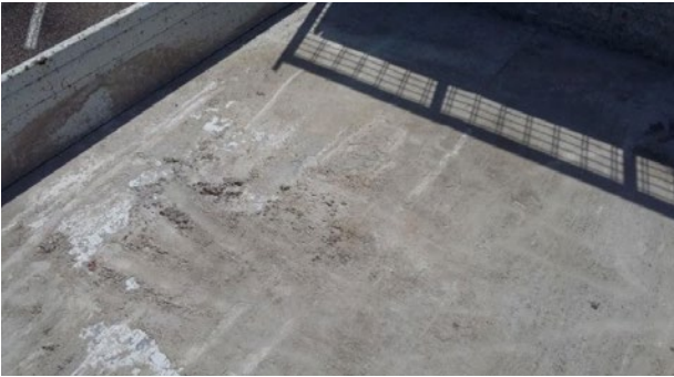
Trace de béton ou produit chimique dont la superficie \geq ¼ de la superficie de la benne
