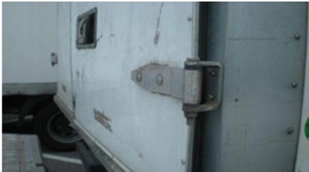
Portes latérales et arrières: portes pliées aux points d'ancrages des charnières, cassées, perforées, ou hors limite économique de la réparation
