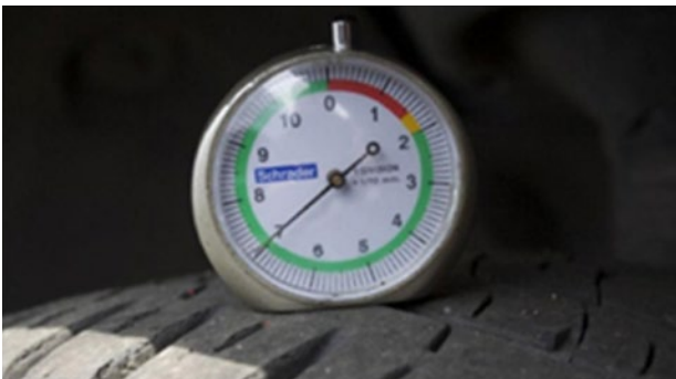
Pneumatiques: profondeur de fond de gorge ≥ 5 mm (CONFORME) Nota : La mesure de l'usure des pneumatiques est réalisée dans la rainure la plus usée du pneumatique.
