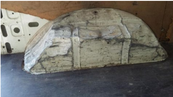
Déformations intérieures: Perforations, découpes, déformations hors limite économique de la réparation. Dépôt dénaturant et non rattrapable (poudre, peinture, etc.) (Passage de roue non valorisable si réparation < 3h)
