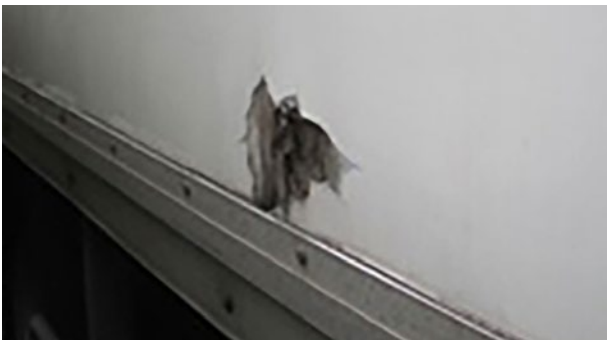
Panneaux latéraux bois: support bois endommagé \geq 20\text{cm}
